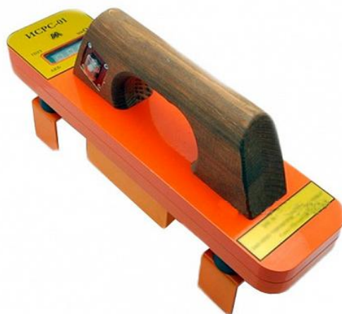
Рисунок 1.7 - Измеритель сопротивления рельсовых стыков ИСРС-01
