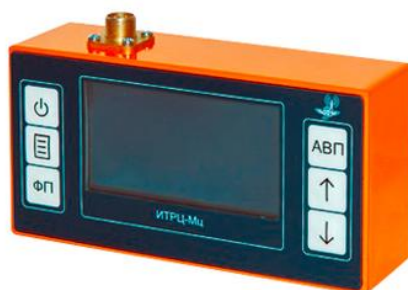
Рисунок 1.9 – Индикатор тока рельсовых цепей ИТРЦ-М
